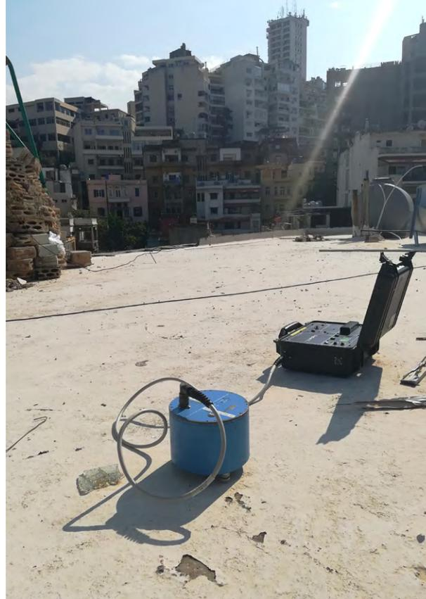
→ **Système d'acquisition (CityShark<sup>TM</sup> et Lennartz 5s) utilisé pour la mesure des vibrations ambiantes dans les bâtiments endommagés de Beyrouth, suite à l'explosion du 4 août 2020** © C. Cornou, IRD/ISTerre
